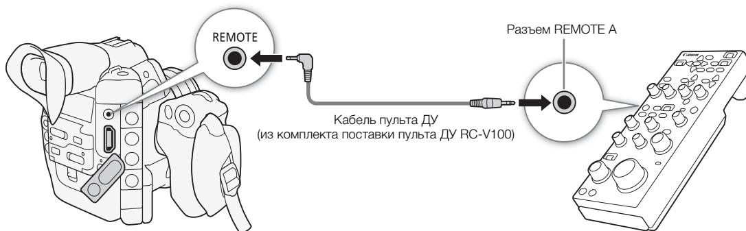
1 Выключите видеокамеру и подсоедините к ней дополнительно приобретаемый пульт дистанционного управления RC-V100.
